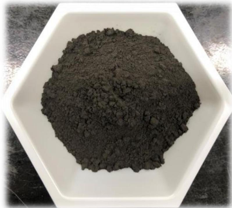
圖 4-1 研磨過篩後之正極材料粉末
