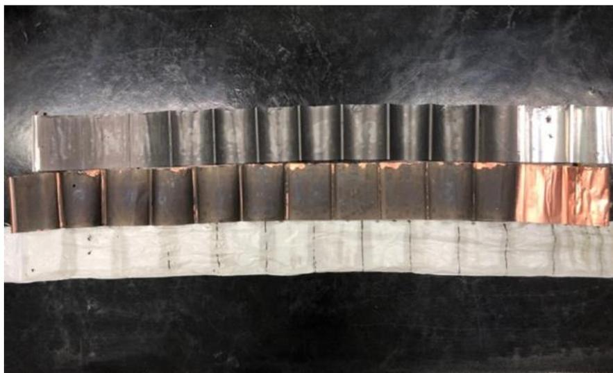
圖 5-2 電池拆解後材料(由上而下分別為正極、負極、隔離膜)
