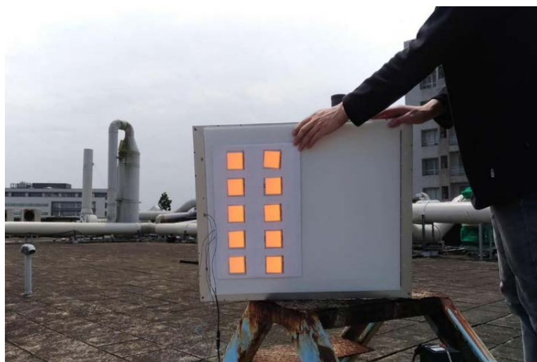
圖二、作品於戶外進行太陽能儲能測試
