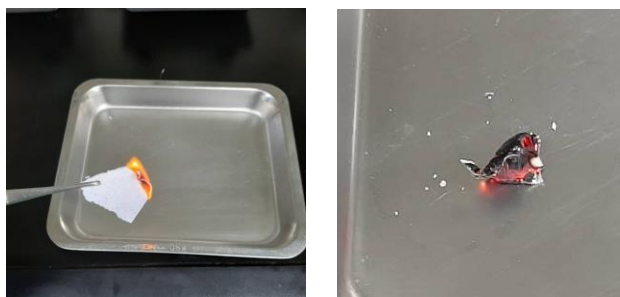
圖四 回收影印紙之阻燃性測試
