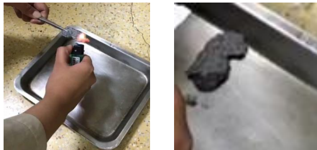
圖四 導電紙之阻燃性測試
