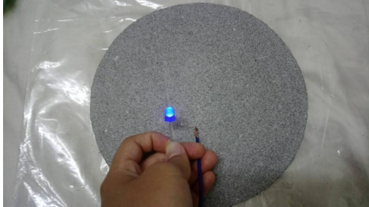
附圖(四)：LED 燈泡導電實際測試圖
