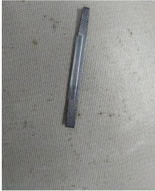
附圖(二)：以 PLA 吸管包覆住導電紙外表
