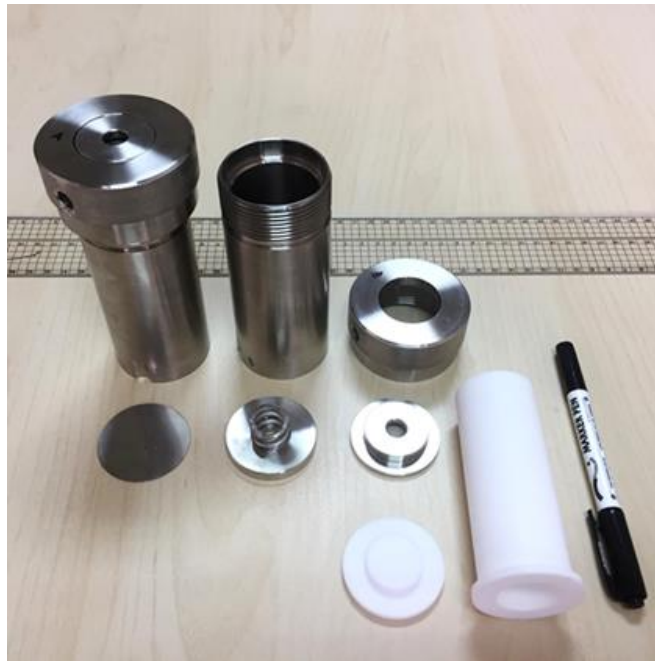
圖二、實驗器具，不鏽鋼外殼與鐵氟龍內膽。
